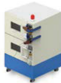
Battery 충,방전 폭파 시험
