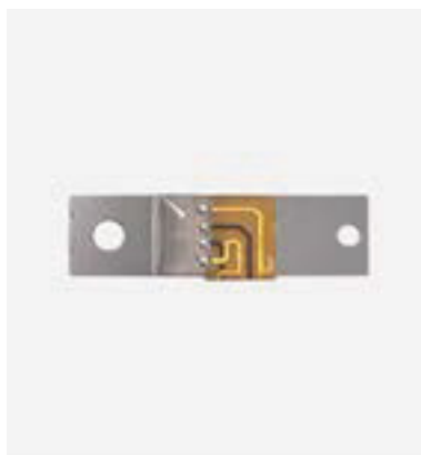
벤딩 모멘트 측정 센서 (변형량 측정)
