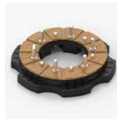
피스톤 헤드 온도 및 압력 측정 무선 시스템
